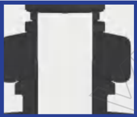
分体式填料压盖 具有自动调心功能
